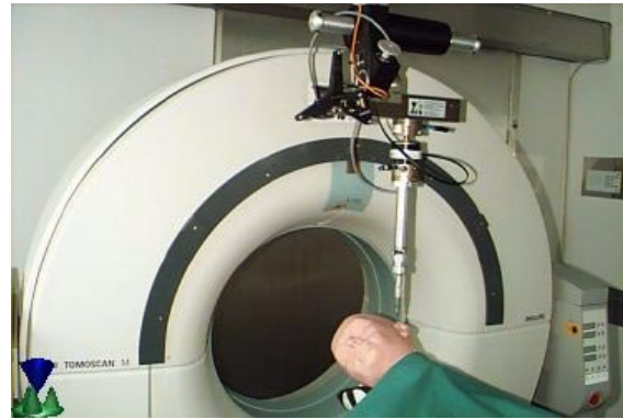
Abb. 2: Mobiles CT mit Lokalisationskörper und chirurgischem Roboter
