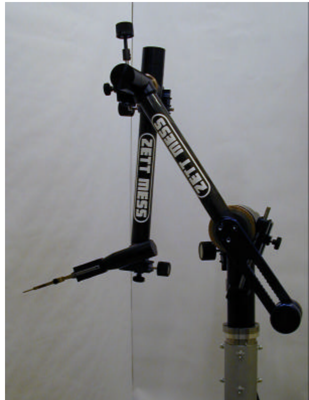
Abbildung 2: Hochpräziser Messmanipulator aus dem Maschinenbau. Zur Anwendung in der Stereotaxie wurde er bereits mit Bremsen und Schneckenrädern ausgestattet.
