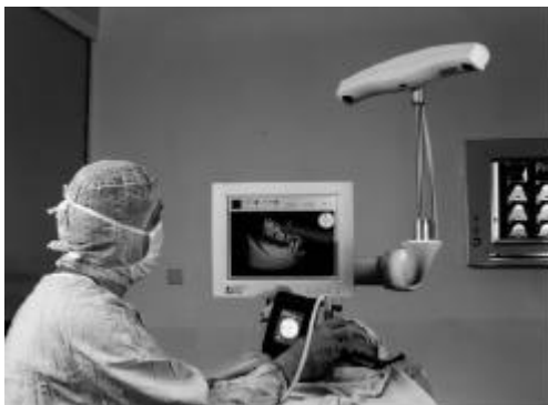
Abb. 1: Das Behandlungssystem RoboDent zum navigierten Einsetzen von Dentalimplantaten.
