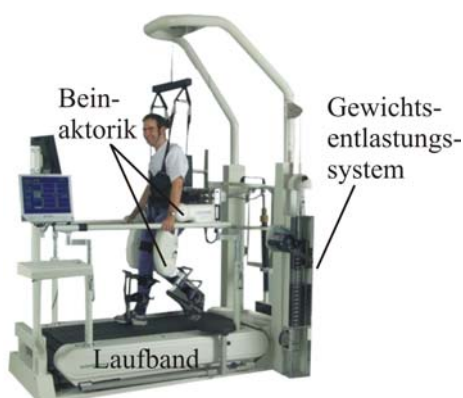
Abb. 1: Automatisiertes Laufbandtraining im Lokomat
