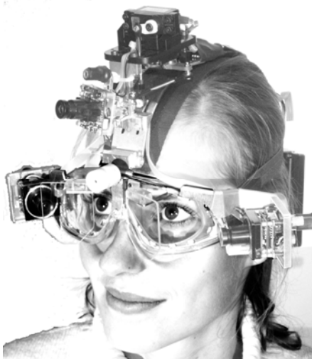
Abb. 1: Prototyp einer blickgesteuerten Kopfkamera mit 3-Achs-Bewegungssteuerung.
