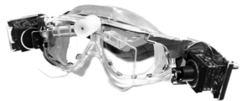
Abb. 2: Mobiles Video-Okulografiesystem mit zwei lateral montierten Kameras, Infrarotspiegeln und zentriert angebrachtem Kalibrationslaser.
