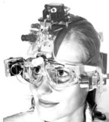
Abb. 1: Mobiles Video-Okulografiesystem als Basis für das blickgesteuerte Kopfkamerasystem.
