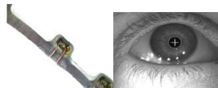
Abb. 3: Anordnung der infrarot-LEDs im Brillenrahmen (links) und daraus resultierende Ausleuchtung des Auges (rechts).
