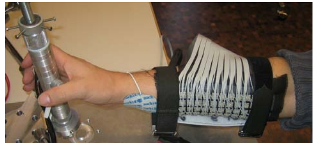
Abb. 1: Die abgebildete 60 Kanal Elektrode ist über einen Multiplexer mit dem stromgesteuerten Stimulator verbunden. Die Selektivität der Muskelaktivierung wurde mit 5 Kraftsensoren (DMS) an jedem Finger gemessen.
