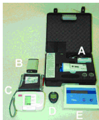
Abb. 1: Patientenkoffer mit Selbsttonometer Ocuton S, Blutzuckermessgerät One Touch Ultra, Blutdruckmessgerät bosomedicus PC, Telemedizinischen Interface (TMI)
