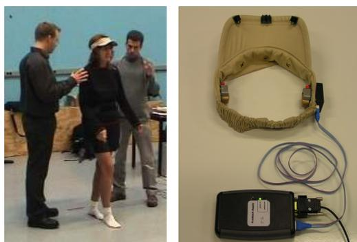
Abb. 1: Komponenten des Biofeedback-Systems. Rechts: System mit am Kopf angebrachten Feedback-Signalwandlern zur Übermittlung vibro-taktiler, auditiver und visueller Informationen über das Körperschwanken. Links: Probandin mit Stirnband, auf dem die Signalwandler angebracht sind.
