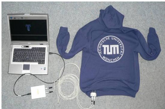
Abb. 5: Textilbasiertes Bewegungsmesssystem mit Auswerteeinheit
