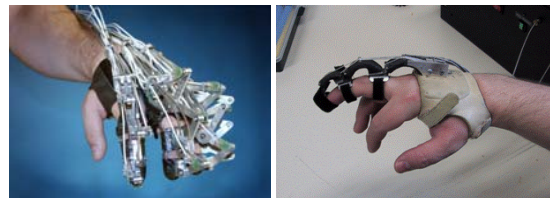
Abb. 1: Links: Das Handexoskelett mit Unterstützung von allen Fingern. Rechts: Das Fingerexoskelett mit drei Kreisbogengelenken.
