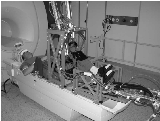
Abb. 1: MARCOS bei Messungen im MRT-Scanner
