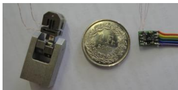
Bild 2. PCB verwendete für Spannungsmessungen und Greifer
