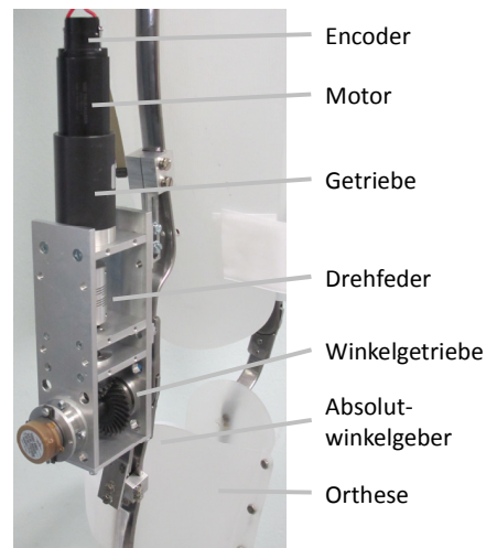
Abbildung 1: Prototyp des seriell-elastischen Antriebs lateral an einer Kniegelenksorthese befestigt.
